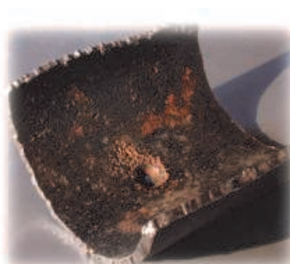
Coroziune locală severă datorată oxigenului
